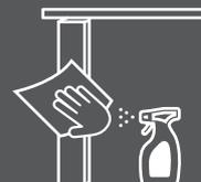
Les structures en revêtement époxy se nettoient avec un chiffon doux et des produits neutres (produits à vitre, ...)
